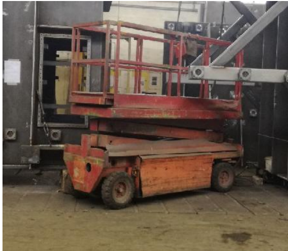
Slika 17. Samohodna dizalica za rad na visini (škare)
