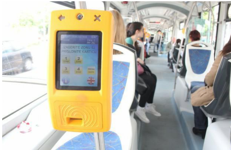
Slika 7. Uređaj za provjeru pokazne karte
