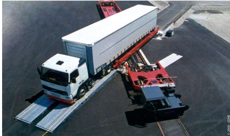
Slika 2: Tehnološki proces utovara/istovara tereta na Modalohr terminalu
