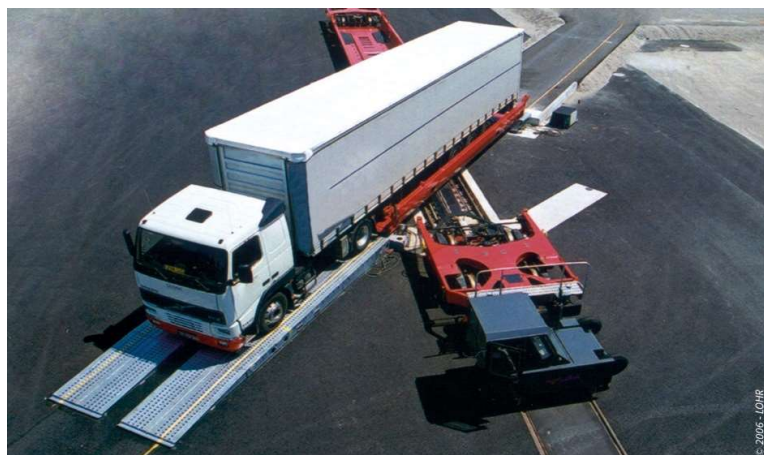
Slika 2: Tehnološki proces utovara/istovara tereta na Modalohr terminalu
