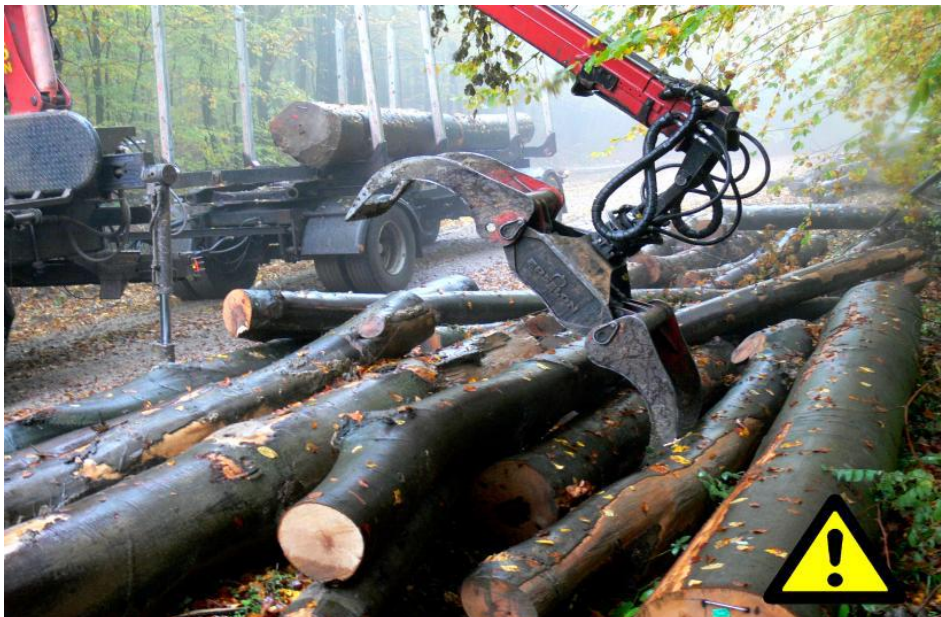
Slika 7. Izvlačenje sortimenata iz hrpe
