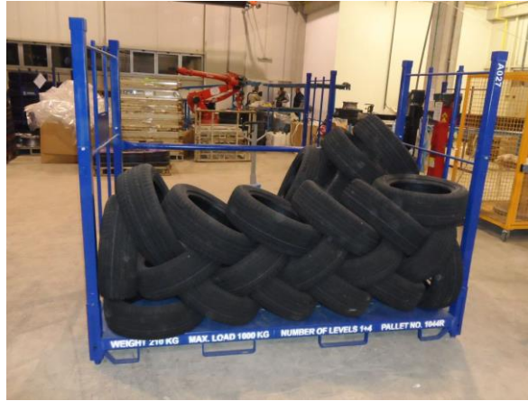
Slika 7 Primjer specijalne palete (metalne)
