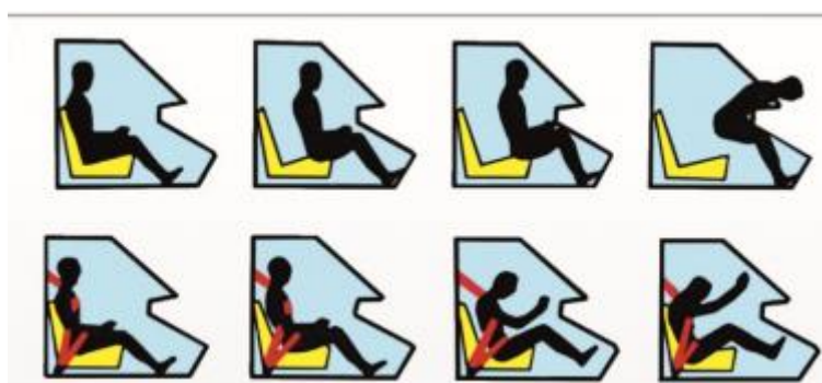
Slika 2. Simulacija kretanja tijela nevezanog i vezanog vozača pri frontalnom sudaru
