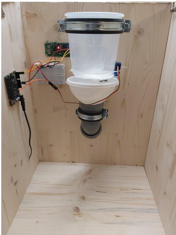
Slika 3. Sustav za isporučivanje hrane
