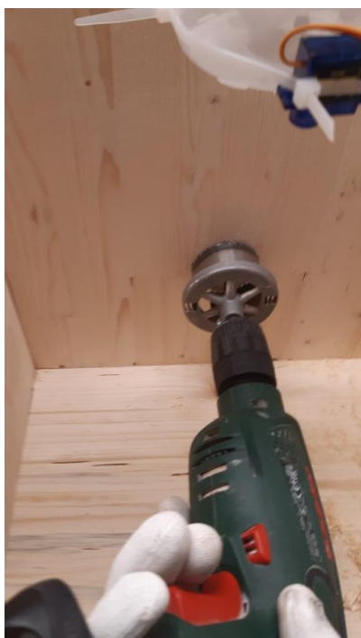
Slika 24. Bušenje rupe na prednjoj stranici za hranilicu
