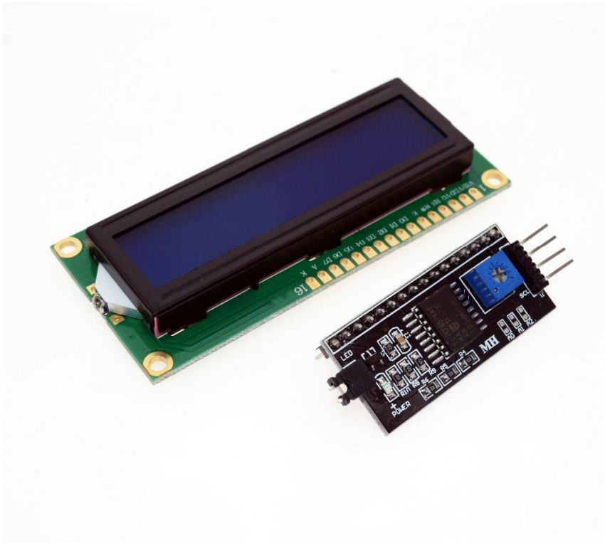
Slika 15. I2C 1602 LCD modul
