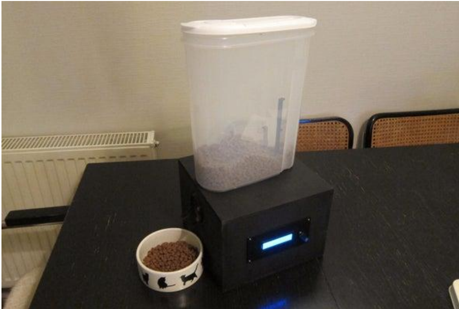
Slika 8. Hranilica izrađena pomoću 3D printera
