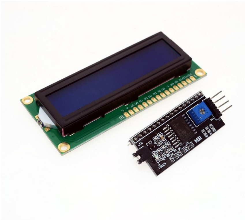
Slika 15. I2C 1602 LCD modul
