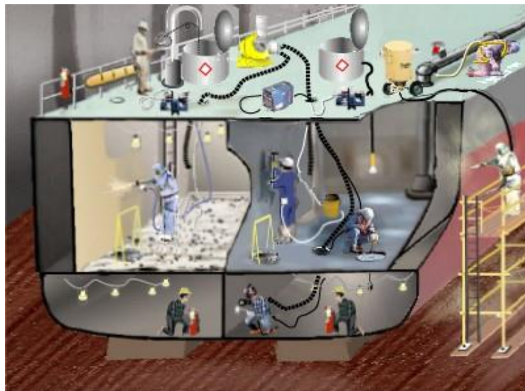
Slika 19. Ventilacija zatvorenih prostora na brodu
