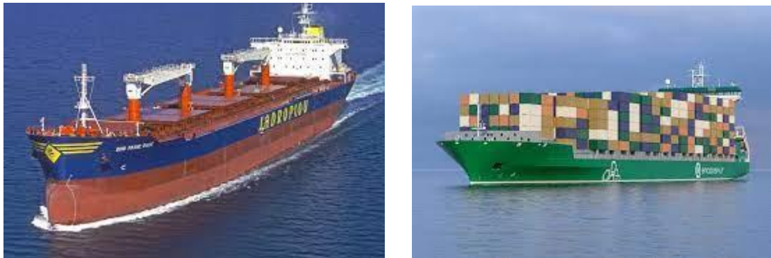
Slika 2. Brod za prijevoz rasutog tereta ( lijevo ) i kontejnera ( desno )
