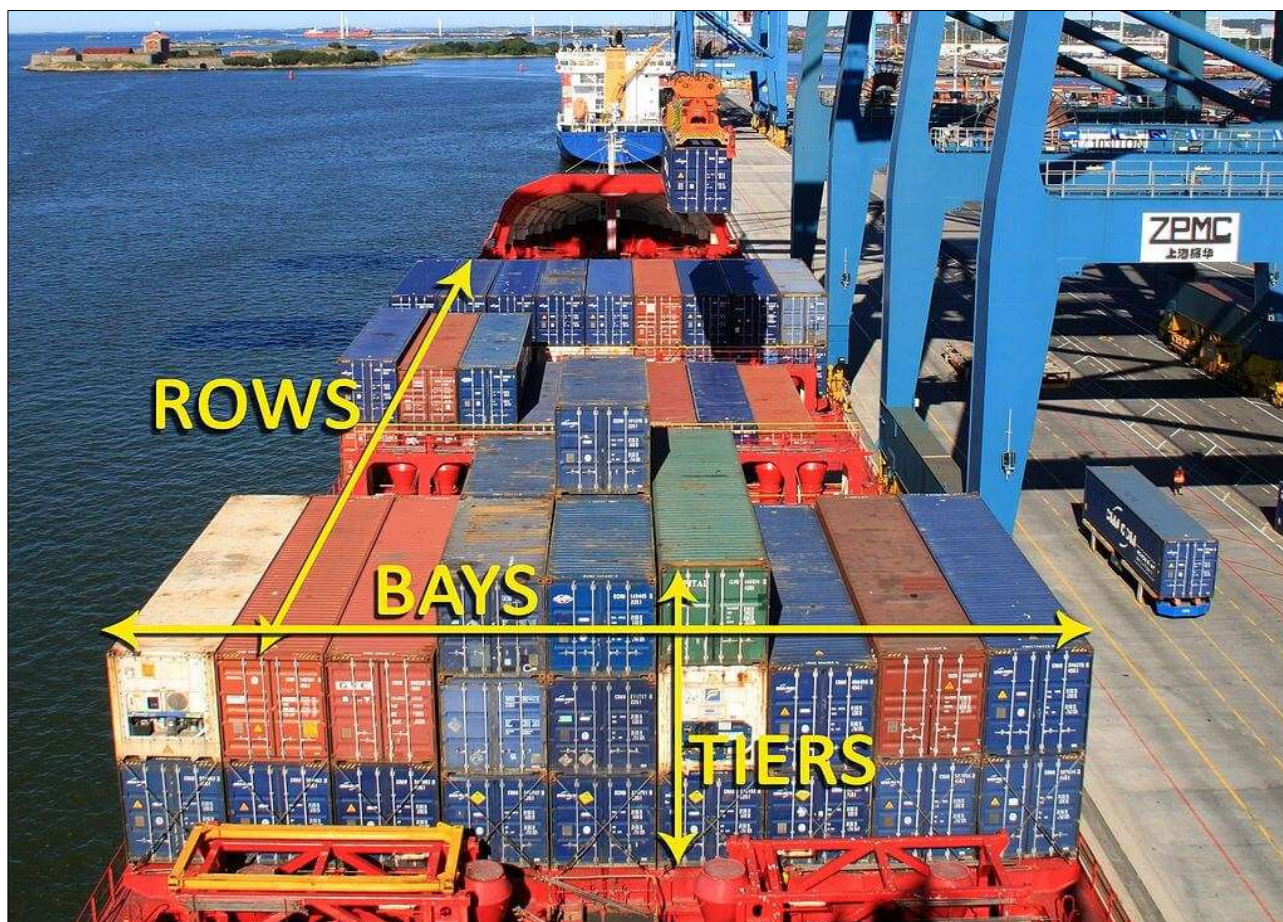
Slika 14 - Slika učinak s aspekta broda: BAY-ROW-TIER
