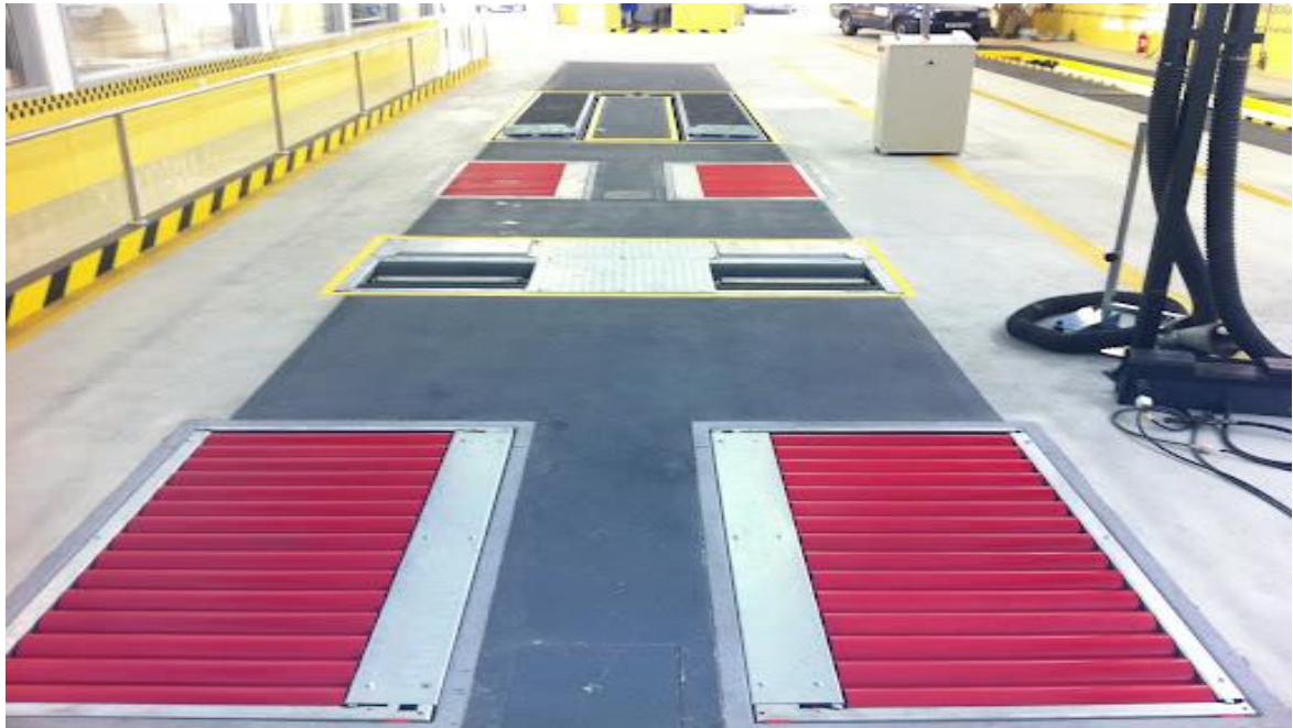
Slika 11. Uređaj za mjerenje kočne sile na obodu kotača (valjci).
