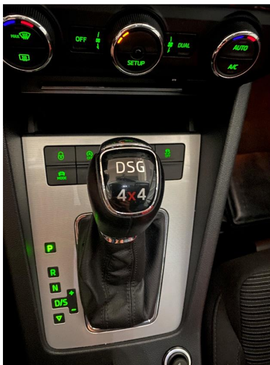
Slika 9 - Ručica DSG mjenjača
