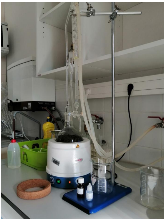
Slika 11. Destilacija uzoraka – izdvajanje eteričnog ulja
