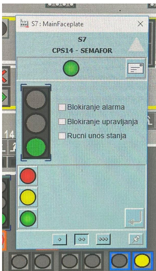
Slika 14. Daljinsko upravljanje semaforom u tunelu Učka
