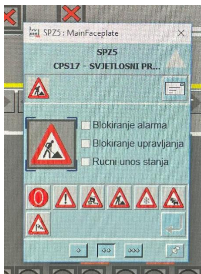
Slika 13. Daljinsko upravljanje prometnim znakom opasnosti na izlazu iz tunela
