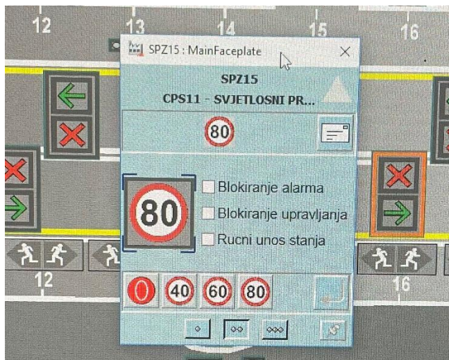
Slika 12. Daljinsko upravljanje prometnim znakom ograničenja brzine
