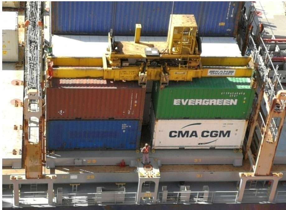
Slika 9. Signalista navodi dizaličara na pravilno spuštanje kontejnera
