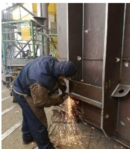
Slika 15. Obrada metala brušenjem – pognuti položaj tijela
