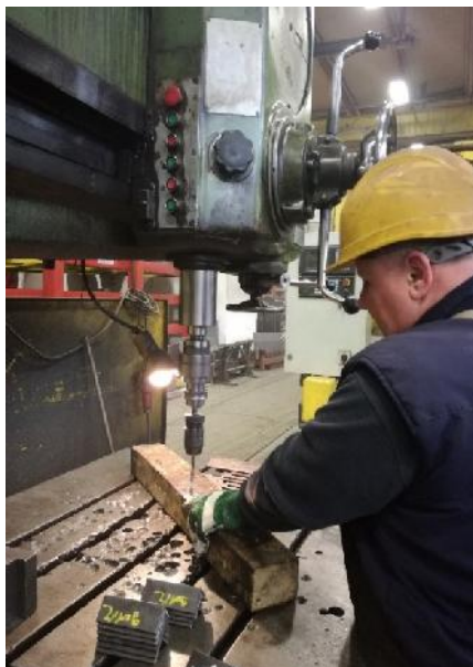
Slika 14. Strojobravar pri radu sa stolnom bušilicom – stoje i položaj
