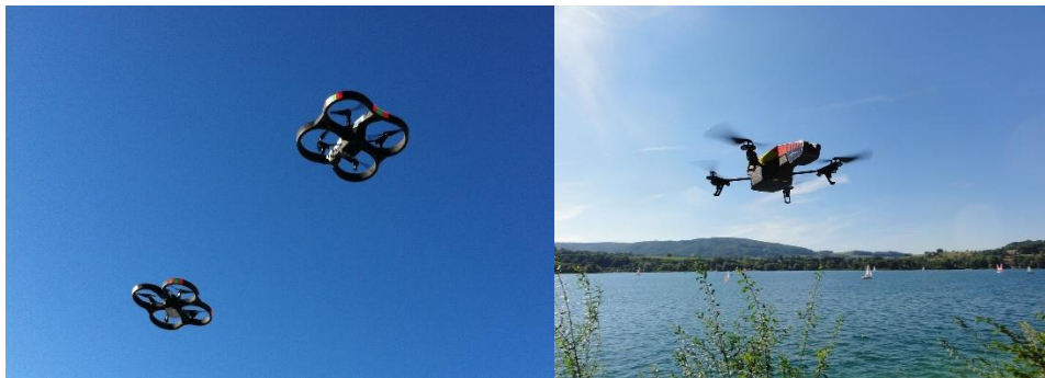
Slika 16.:Lijevo-AR.Drone sa trupom za zatvoren prostor. Desno-AR.Drone za otvoren prostor
