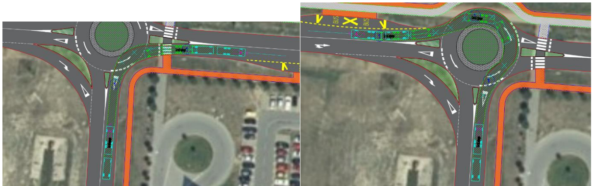
Slika 20. Provjera provoznosti privoza I
