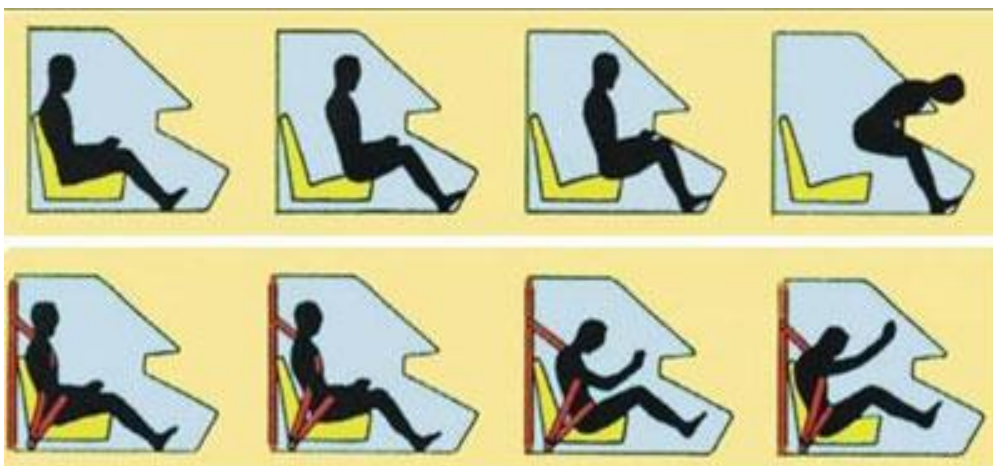
Slika7. Simulacija kretanja tijela vozača pri frontalnom sudaru sa i bez sigurnosnog pojasa
