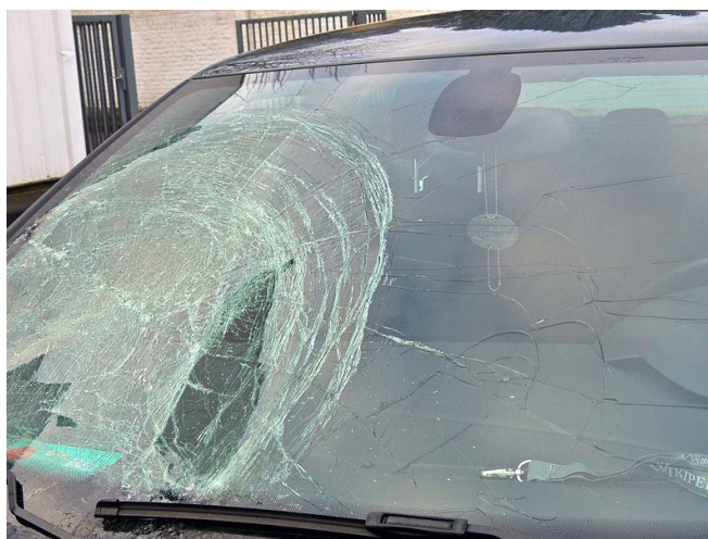
Slika8. Višeslojno vjetrobransko staklo
