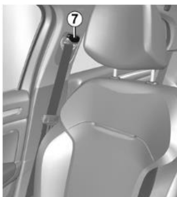
Slika 6. Papučica za podešavanje sigurnosnog pojasa po visini
