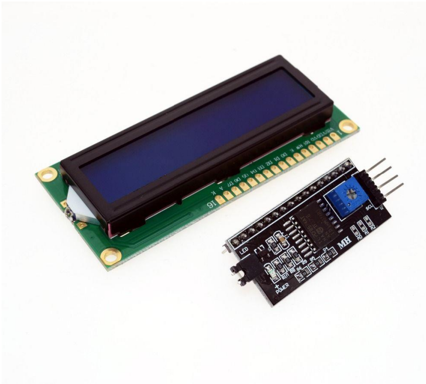
Slika 15. I2C 1602 LCD modul
