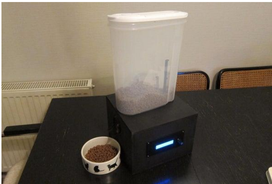
Slika 8. Hranilica izrađena pomoću 3D printera
