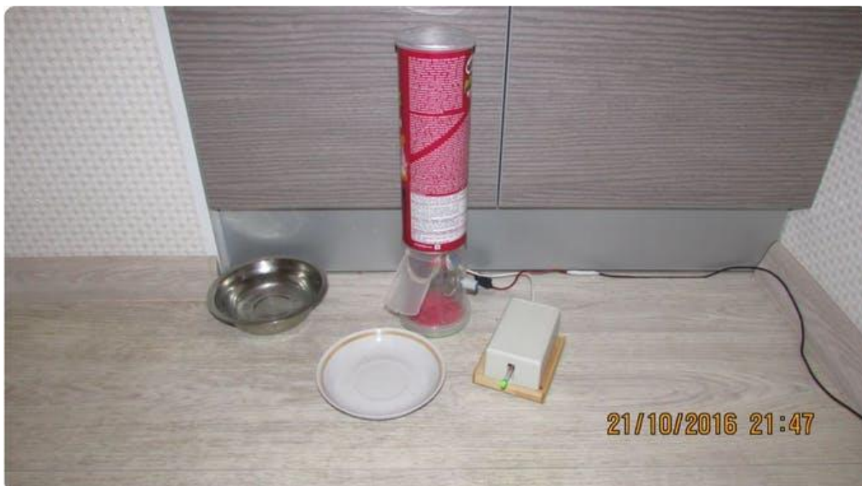
Slika 7. Hranilica s prekidačem
