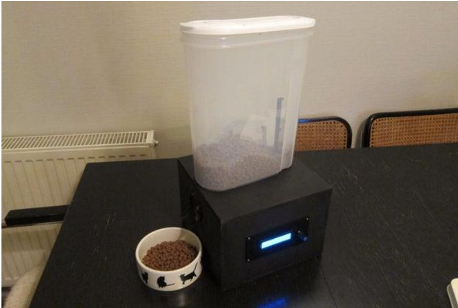
Slika 8. Hranilica izrađena pomoću 3D printera
