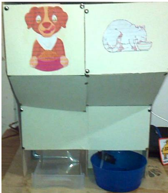
Slika 12. Automatska hranilica i pojilica s pumpom
