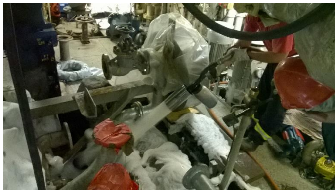
Slika 31. Prekrivanje zauljenih površina pjenom
