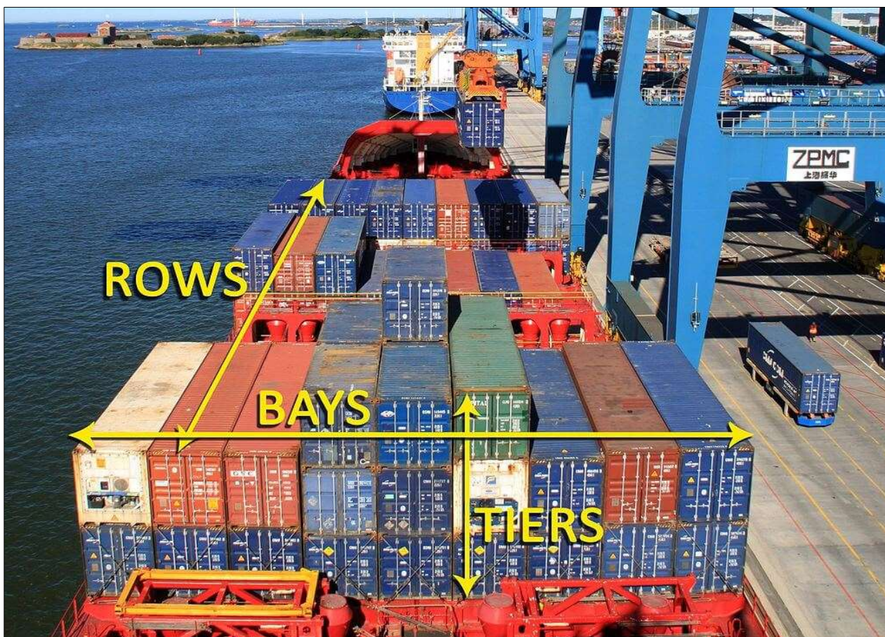
Slika 14 - Slika učinak s aspekta broda: BAY-ROW-TIER
