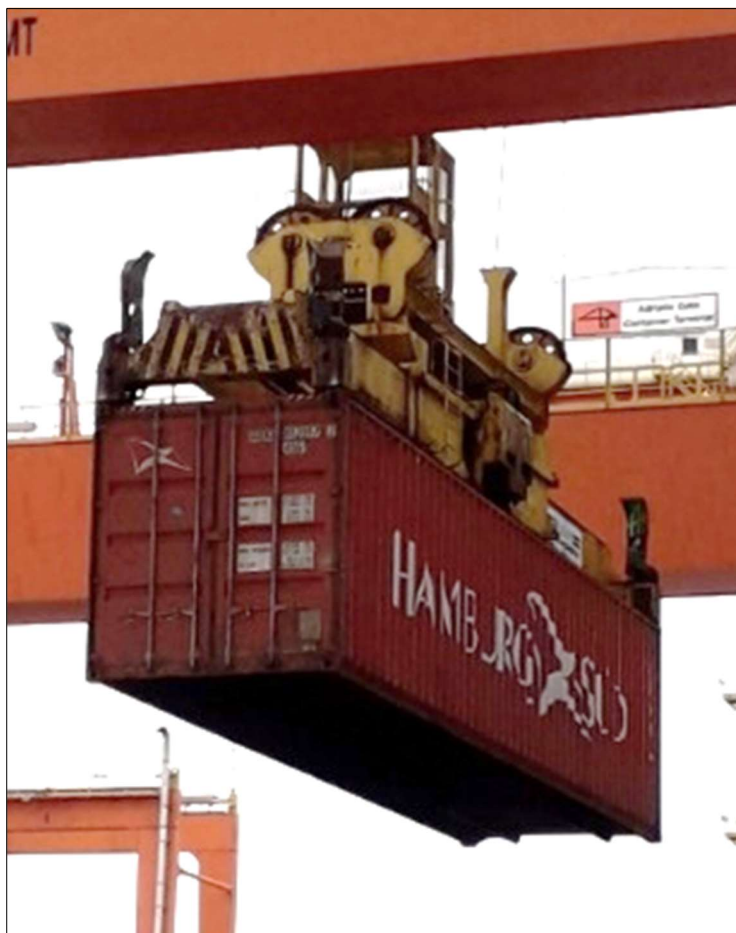
Slika 7 - Hvatač (Spreader) u radu AGCT -Luka Rijeka
