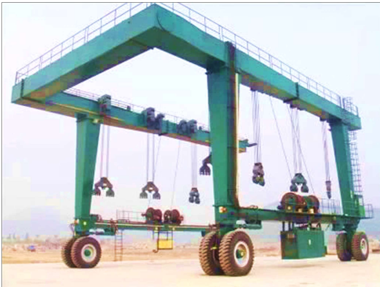
Slika 8 - Dizalice RTG na gumenim kotačima
