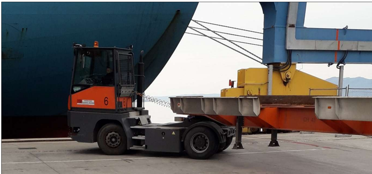
Slika 11 - Tegljača ( traktora ) s prikolicom za transport kontejnera
