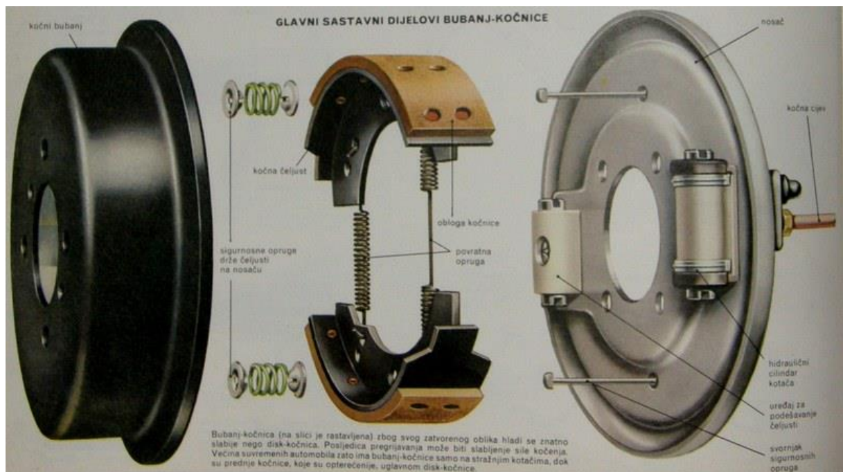
Slika 2. Prikaz bubanj kočnice.
