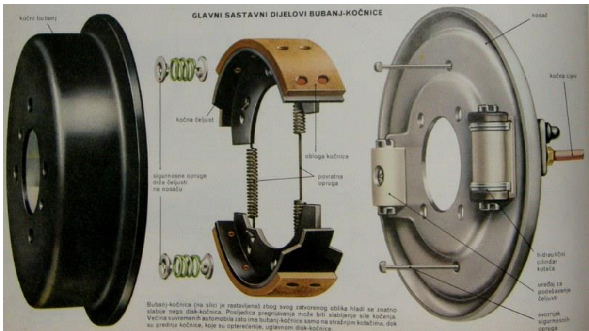
Slika 2. Prikaz bubanj kočnice.
