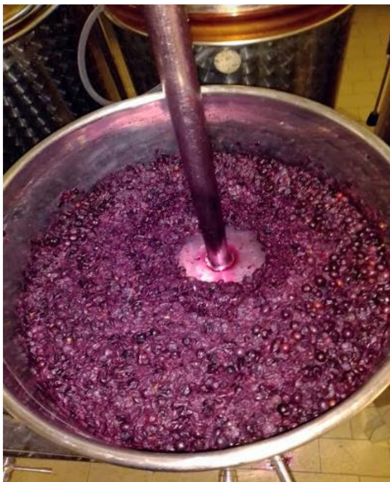
Slika 3. Prikaz metode potapanja klobuka masulja
