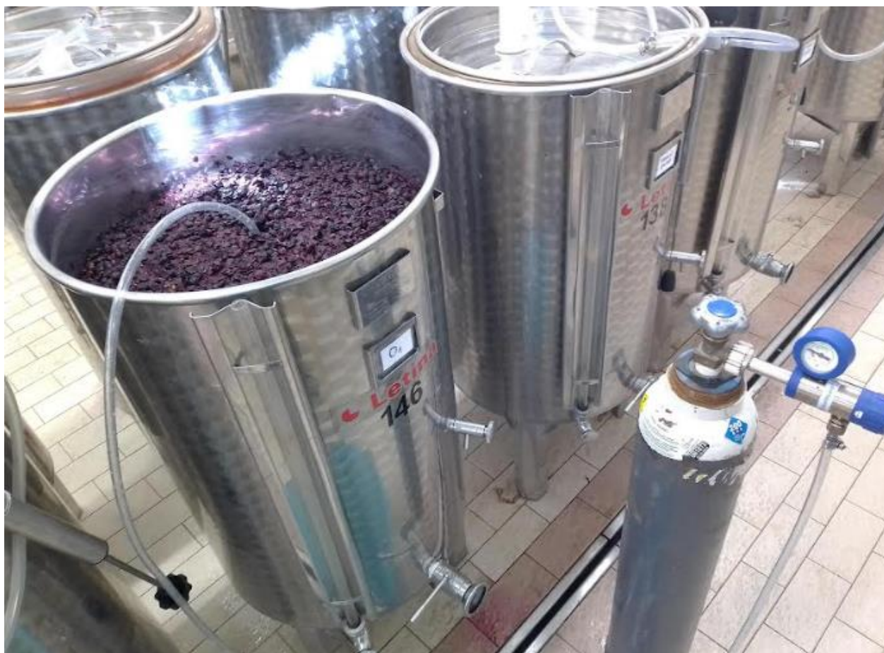
Slika 7. Način doziranja i dodavanja kisika u mošt
