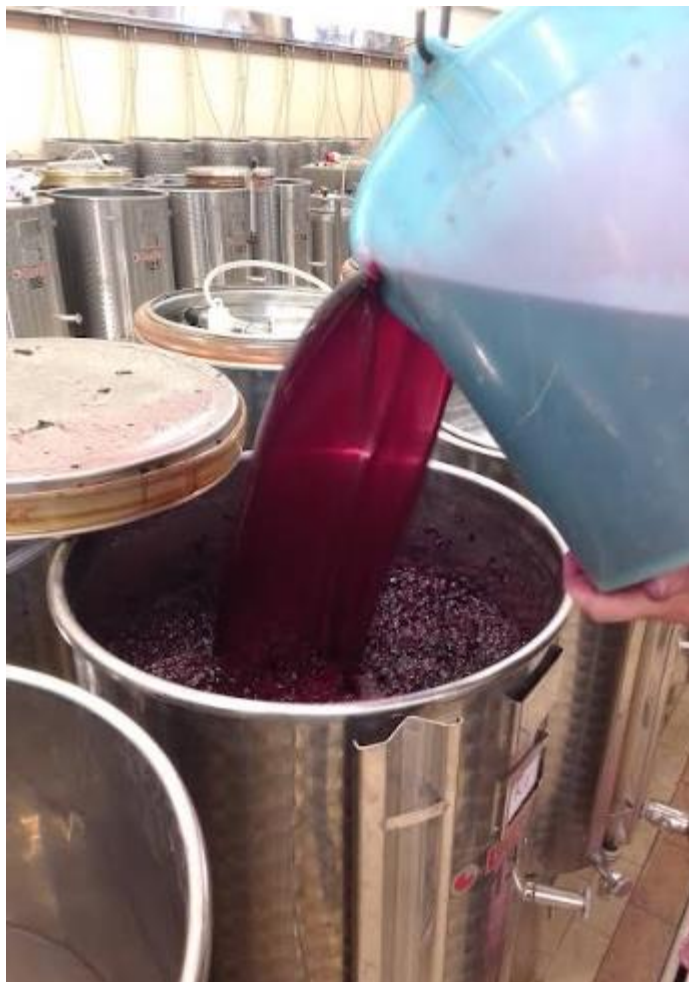
Slika 6. Prelijevanje mošta preko klobuka masulja
