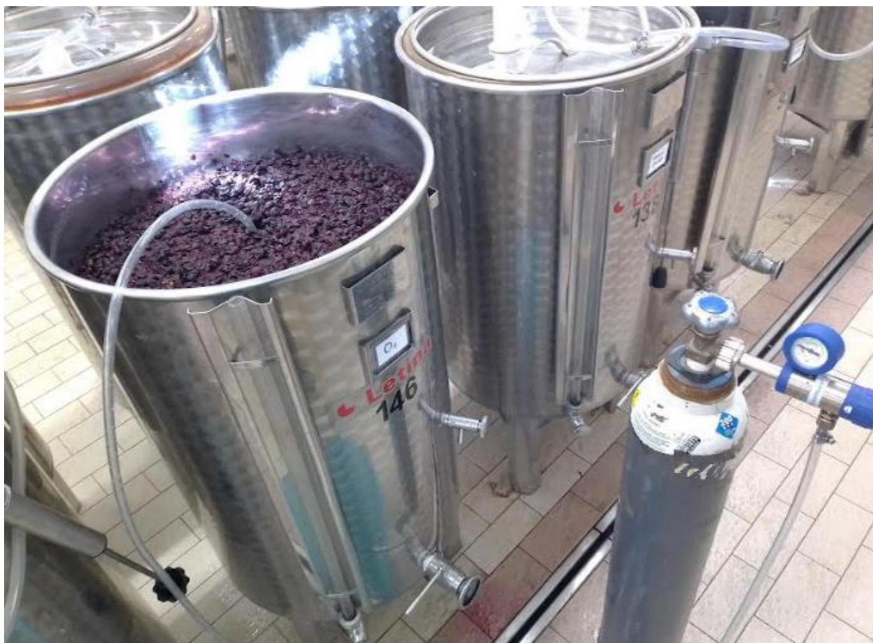
Slika 7. Način doziranja i dodavanja kisika u mošt
