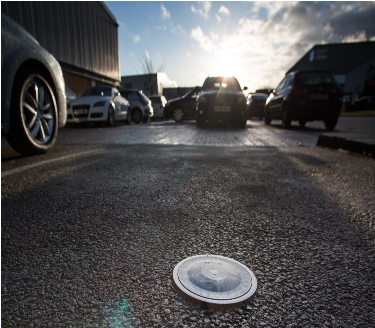
Slika 21. Primjer magnetnog senzora postavljenog na pametno parkiralište
