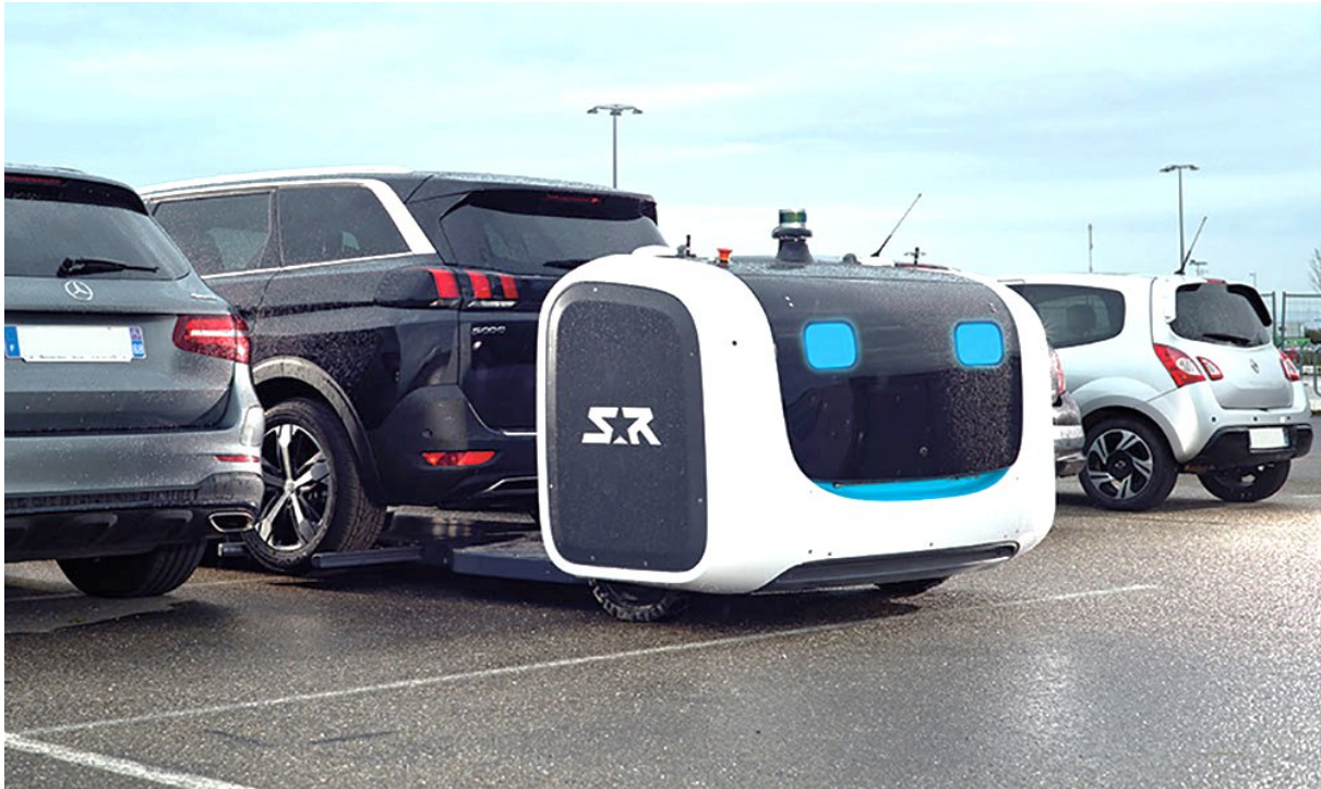
Slika 24. Prikaz parkiranja pomoću autonomnog robota
