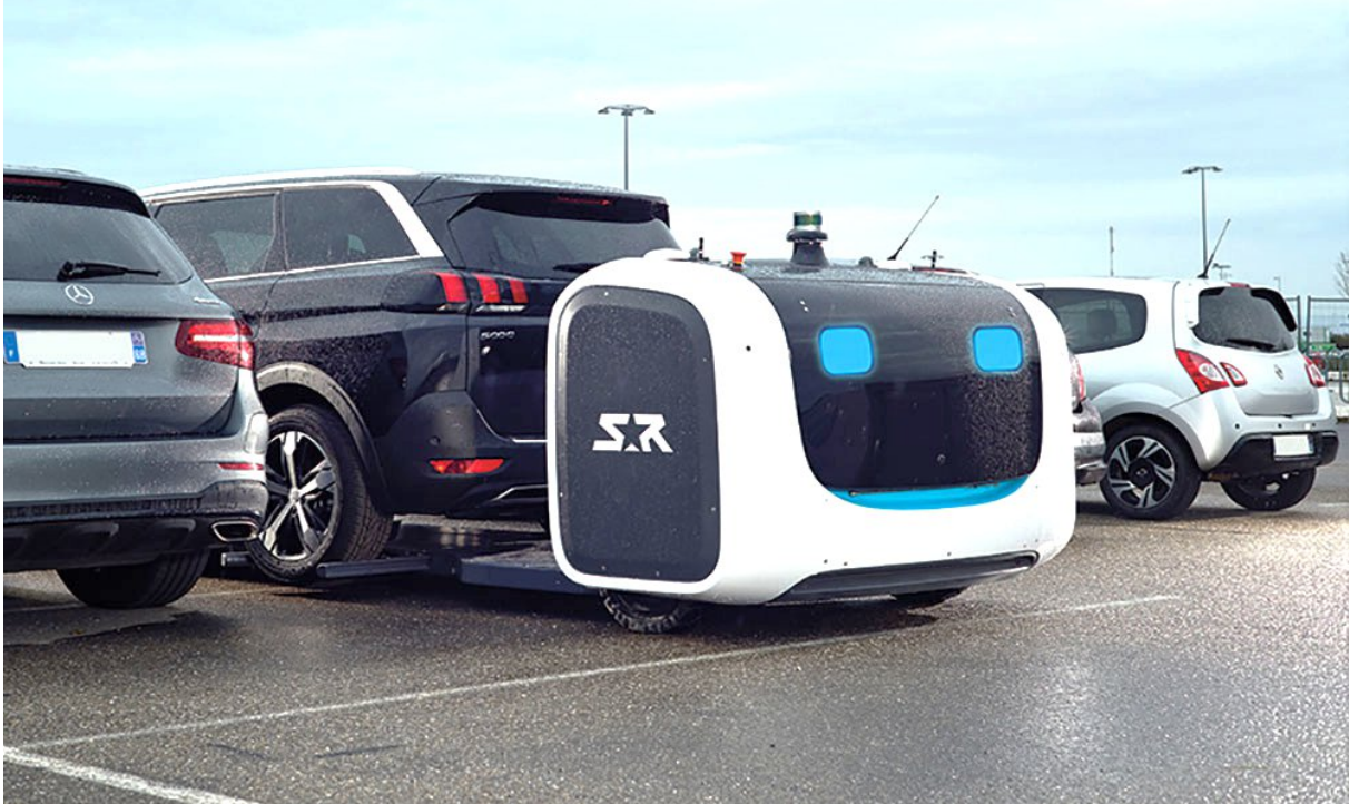
Slika 24. Prikaz parkiranja pomoću autonomnog robota
