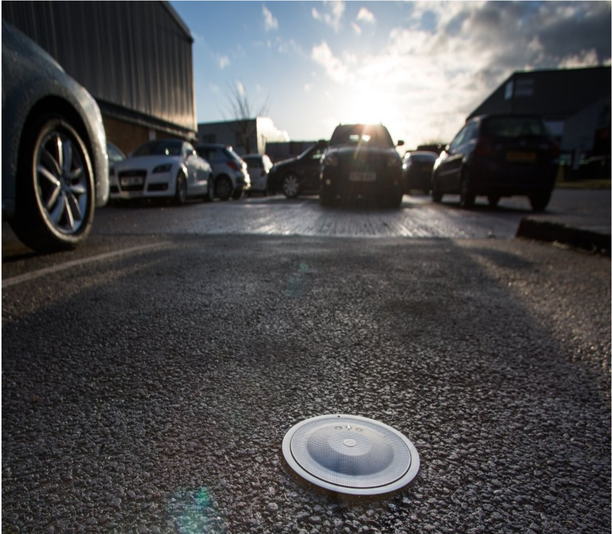
Slika 21. Primjer magnetnog senzora postavljenog na pametno parkiralište
