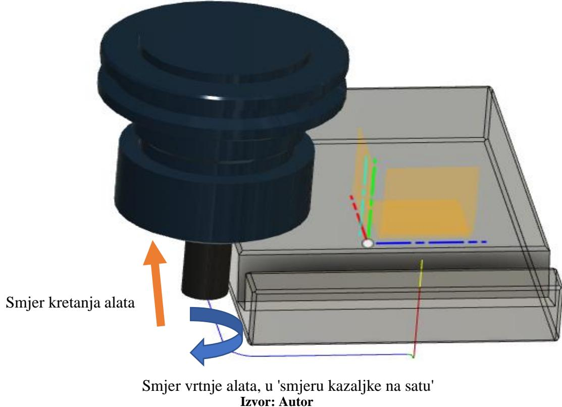
Za glodanje kanala potrebno je glodalo koje je manje od kanala koji će se oglodati. Odabrano je glodalo naziva 'Master Alu VHM vretenasto glodalo TPC 6 mm'. To glodalo je namijenjeno za
