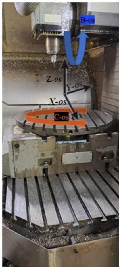
Slika 50. Prikaz 5 osi stroja
