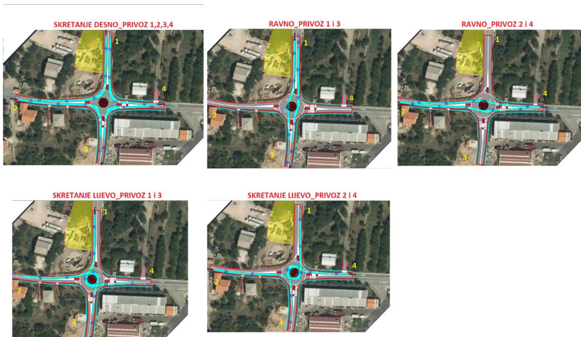
Slika 35. Prolaz mjerodavnog vozila mini kružnim raskrižjem
