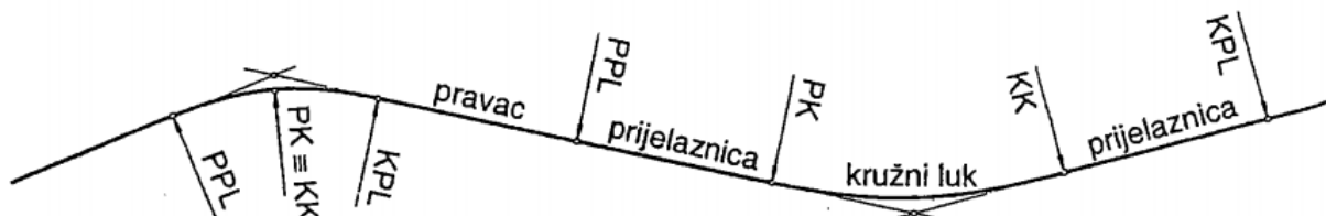
Slika 1. Izgled osi ceste u tlocrtu
