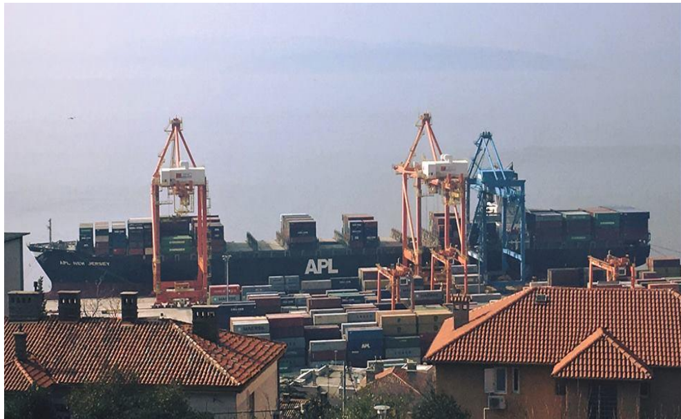
Slika 19. Tri obalne dizalice rade na jednoj matici
