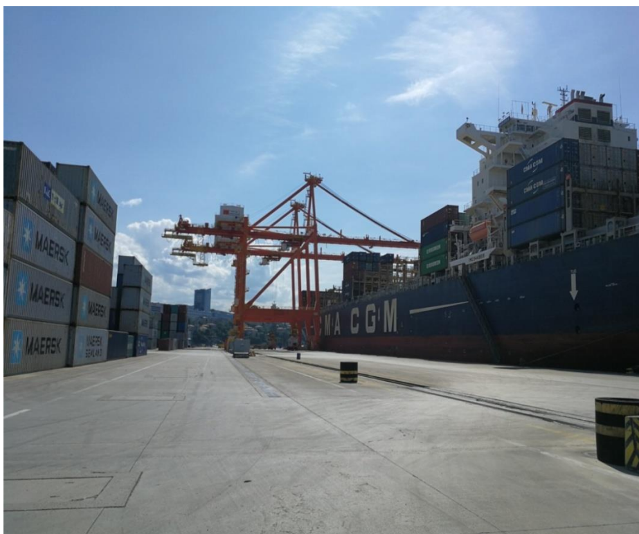
Slika 3. Manipulacija kontejnera s dvije obalne dizalice
