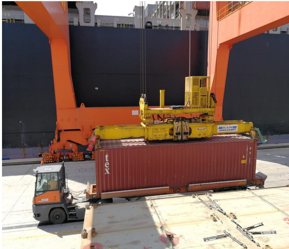
Slika 6. Fliperi navode dizaličara da lakše zahvati kontejner
