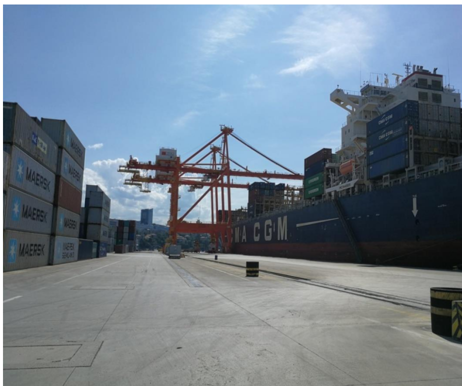
Slika 3. Manipulacija kontejnera s dvije obalne dizalice
