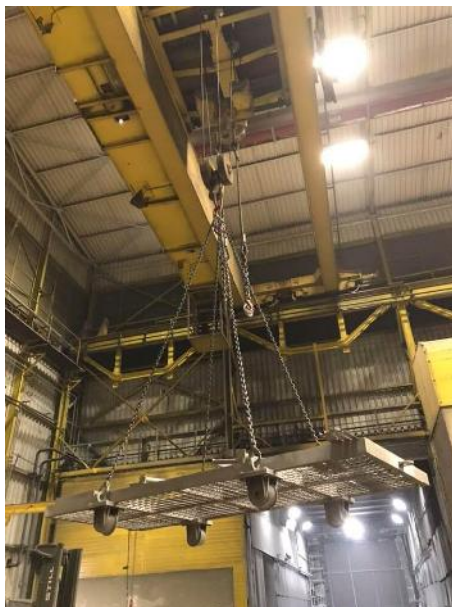
Slika 12. Prenosenje tereta mosnom dizalicom
