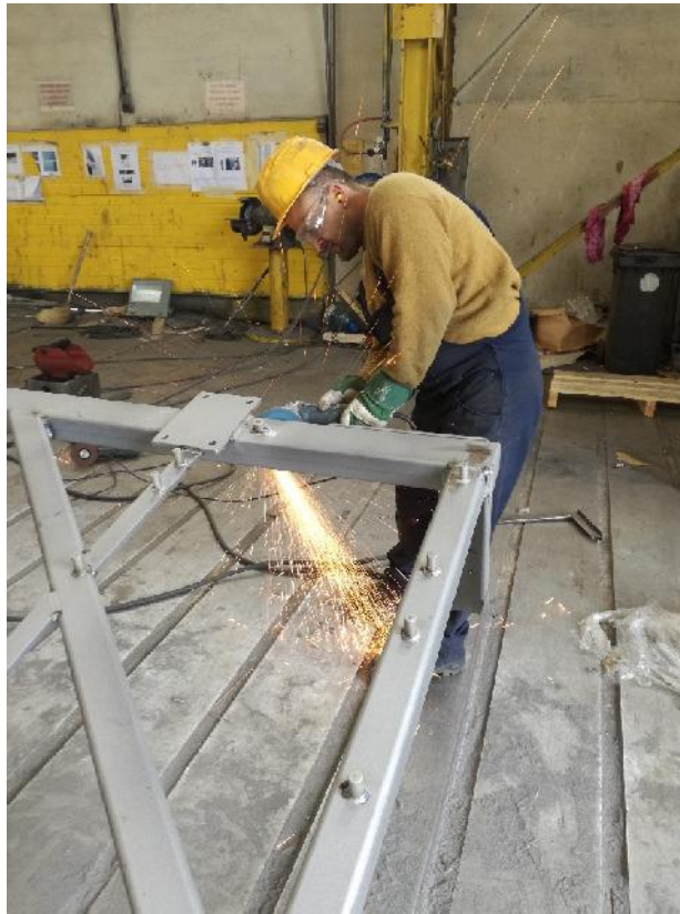
Slika 5. Ručno brušenje površine ravnog oblika
