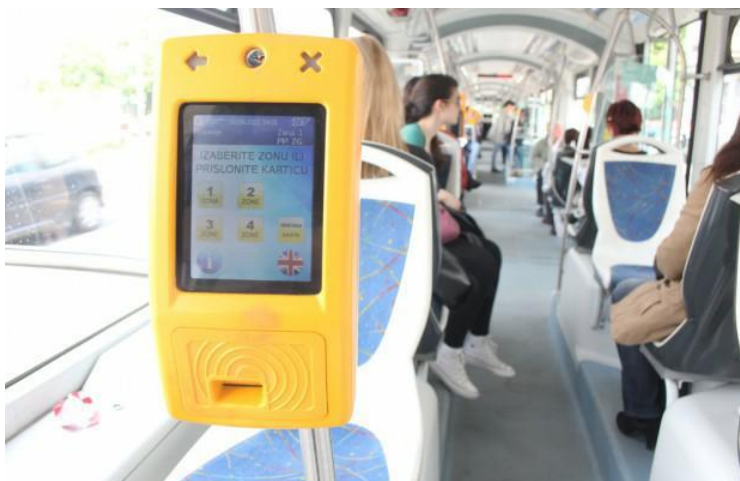
Slika 7. Uređaj za provjeru pokazne karte
