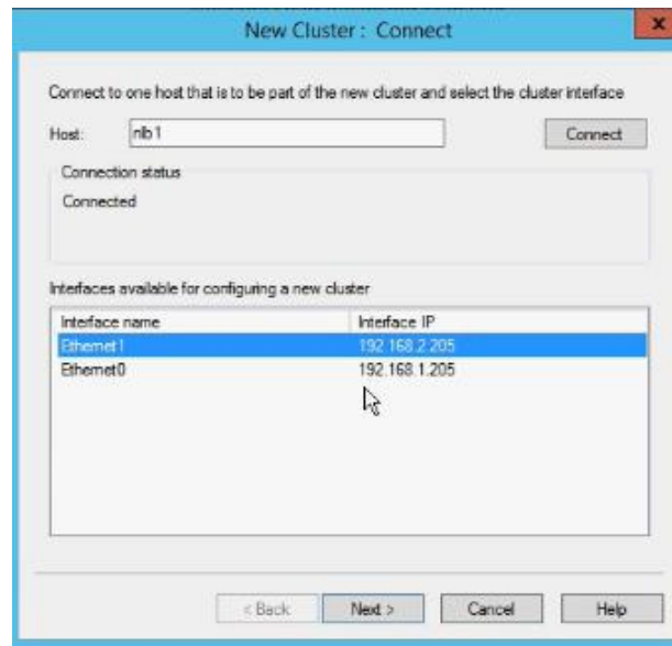
Slika 56. Definiranje servera koji ulaze u NLB „cluster“
