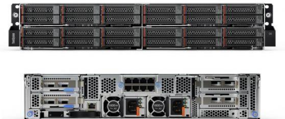
Slika 10. Primjer fizičkog servera sa Hot i Cold Swap komponentama
