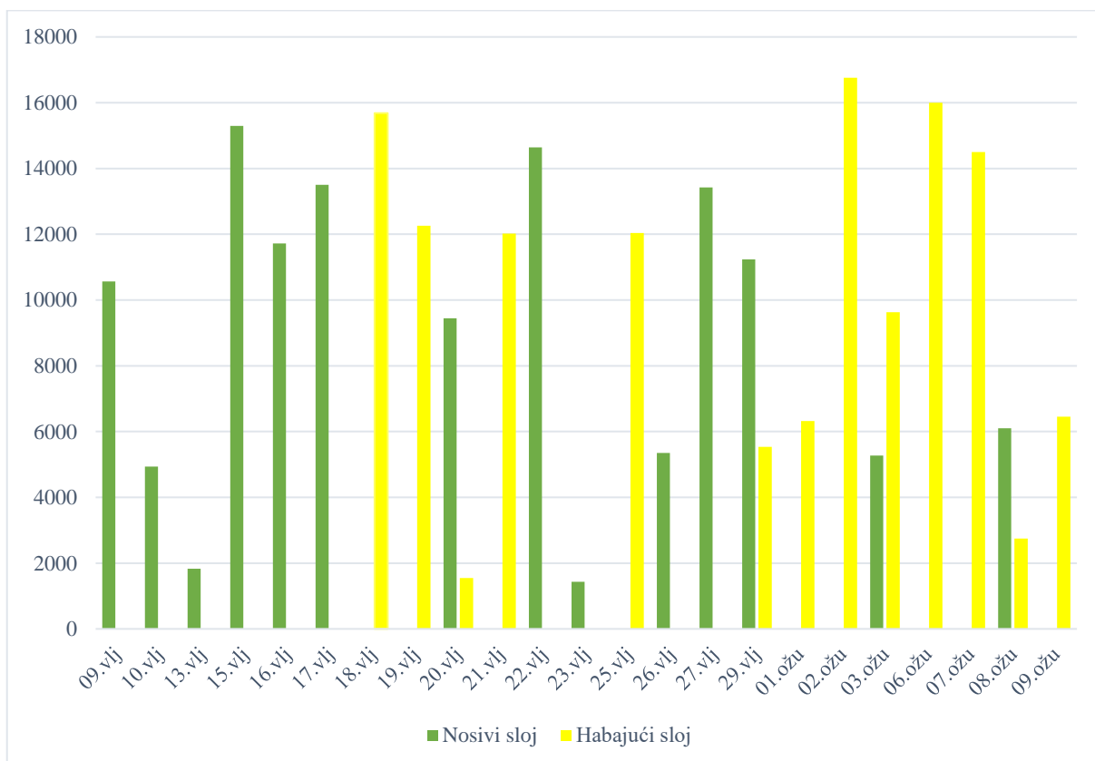
Grafikon 4. Površina ugrađene asfaltne mješavine (nosivi i habajući sloj) prema kalendarskim danima
