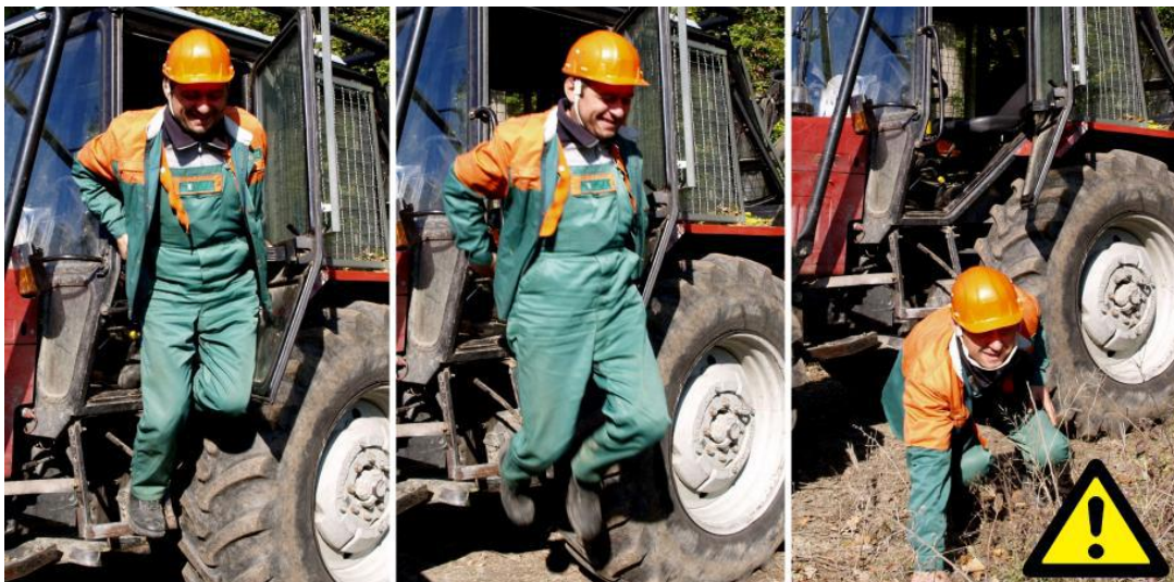
Slika 11. Nepravilan izlazak iz stroja
