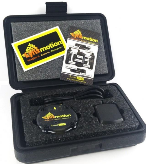
Slika 12.:Quadriino Nano sustav za kontrolu leta
