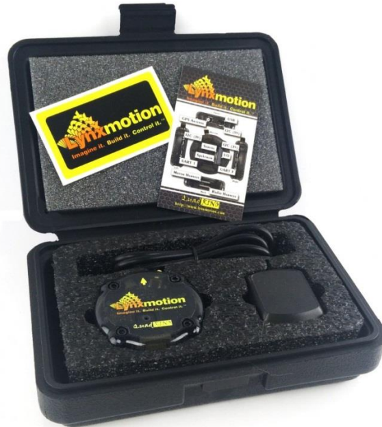
Slika 12.:Quadriino Nano sustav za kontrolu leta
