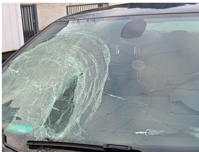
Slika8. Višeslojno vjetrobransko staklo
