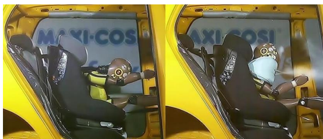
Slika 14. Dječja sjedalica bez i sa zračnim jastukom
