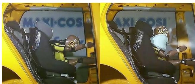
Slika 14. Dječja sjedalica bez i sa zračnim jastukom
