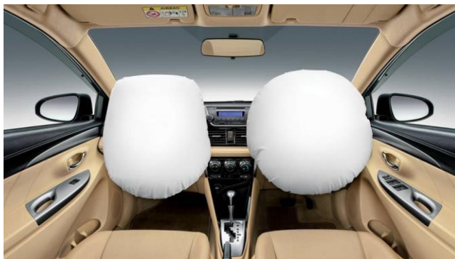
Slika 12. Sigurnosni zračni jastuk
