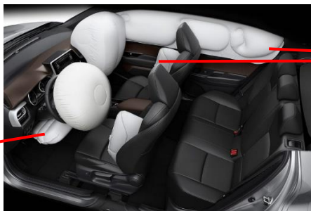
Slika 13. Sigurnosni zračni jastuk za koljena i bočni zračni jastuk
