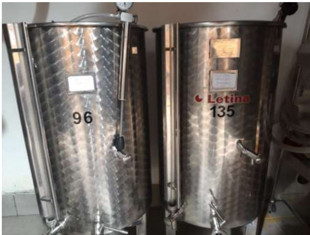
Slika 12. Bačve korištene za alkoholnu fermentaciju sa S. cerevisiae kvascem D 254
