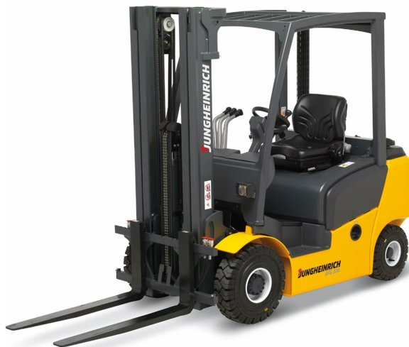
Slika 1 Čeoni viličar, model DFG/TFG 316-320
