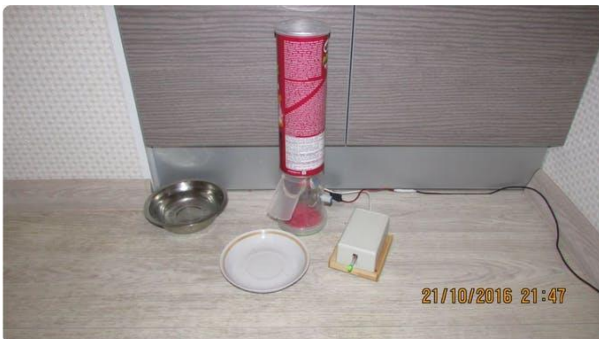
Slika 7. Hranilica s prekidačem
