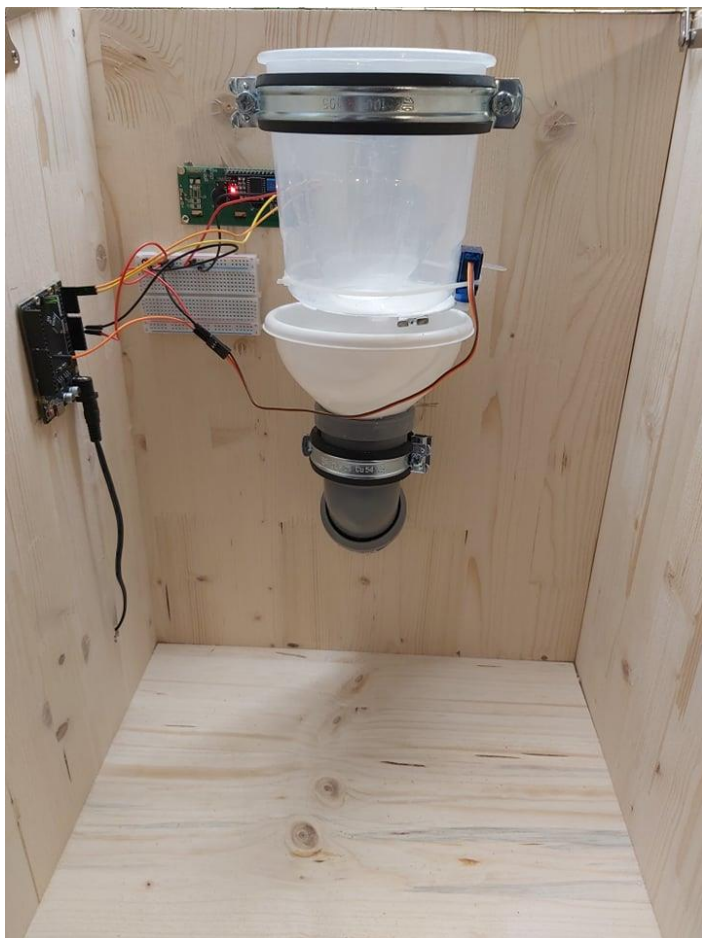
Slika 3. Sustav za isporučivanje hrane
