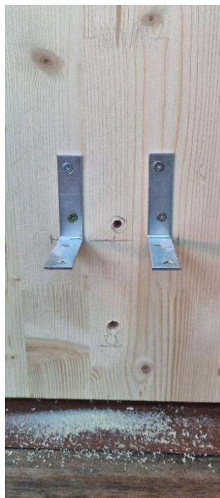
Slika 25. Bušenje rupa za pojilicu na stražnjoj stranici
