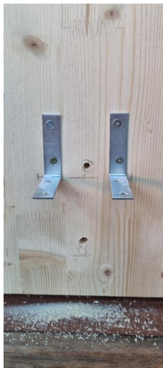
Slika 25. Bušenje rupa za pojilicu na stražnjoj stranici
