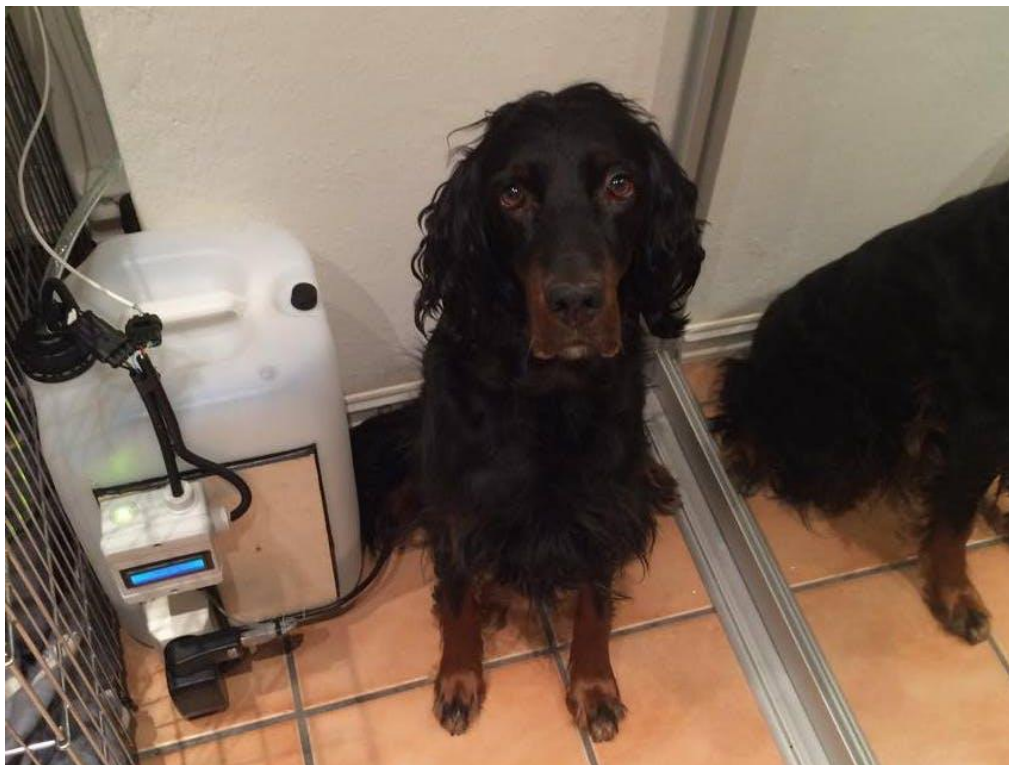
Slika 10. Pojilica za pse sa ultrazvučnim senzorom i pumpom
