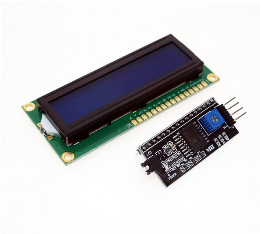
Slika 15. I2C 1602 LCD modul
