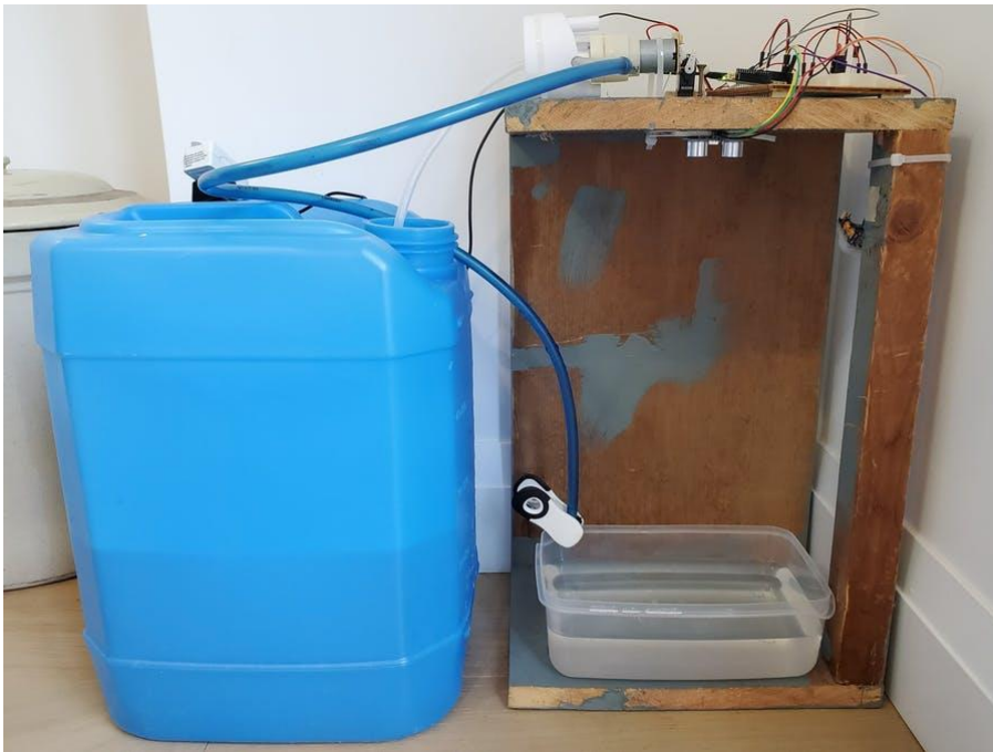
Slika 9. Pojilica s ultrazvučnim senzorom
