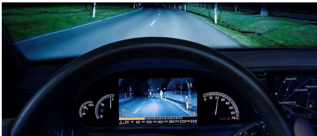
Slika 15. Sustav noćnog vida u vozilu
