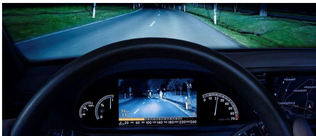
Slika 15. Sustav noćnog vida u vozilu
