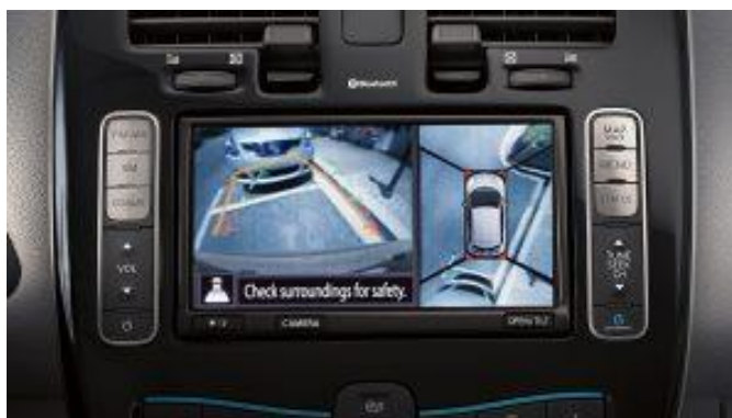
Slika 23. Around View Monitor u vozilu
