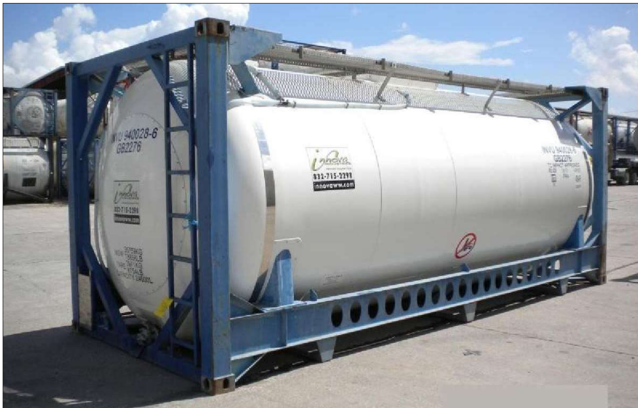
Slika 2 - Kontejneri za plinove i kontejneri za tekućine
