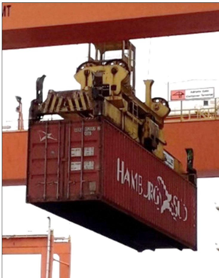
Slika 7 - Hvatač (Spreader) u radu AGCT -Luka Rijeka
