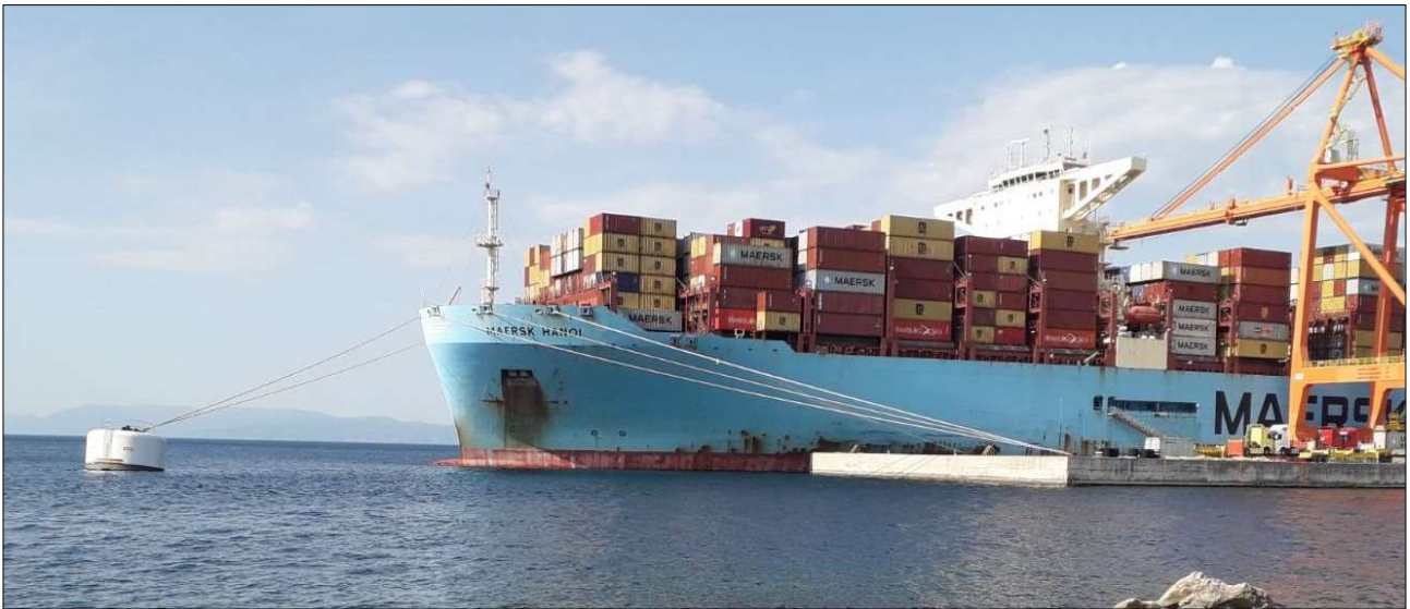
Slika 22 - Priveza broda za plutaču
