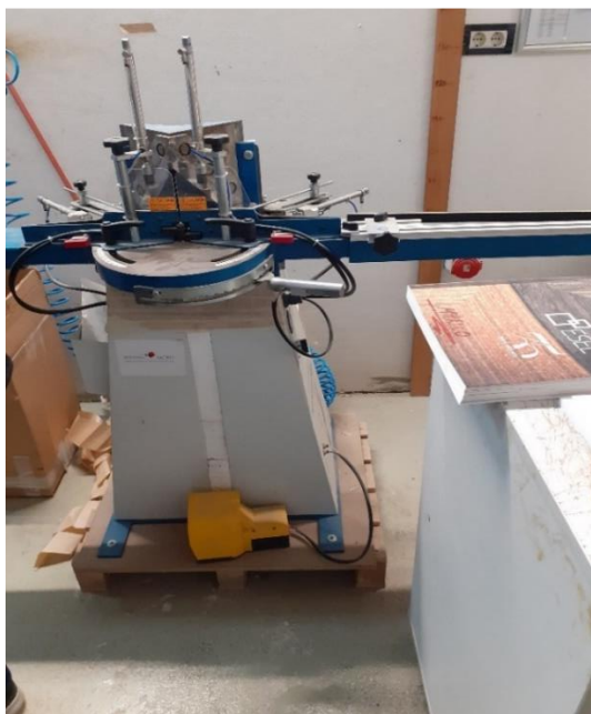
Slika 3. Giljotina za rezanje Pilm International
