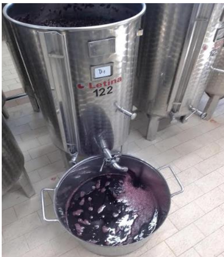
Slika 4. Odvajanje tekućeg volumena mošta tijekom metode delestage
