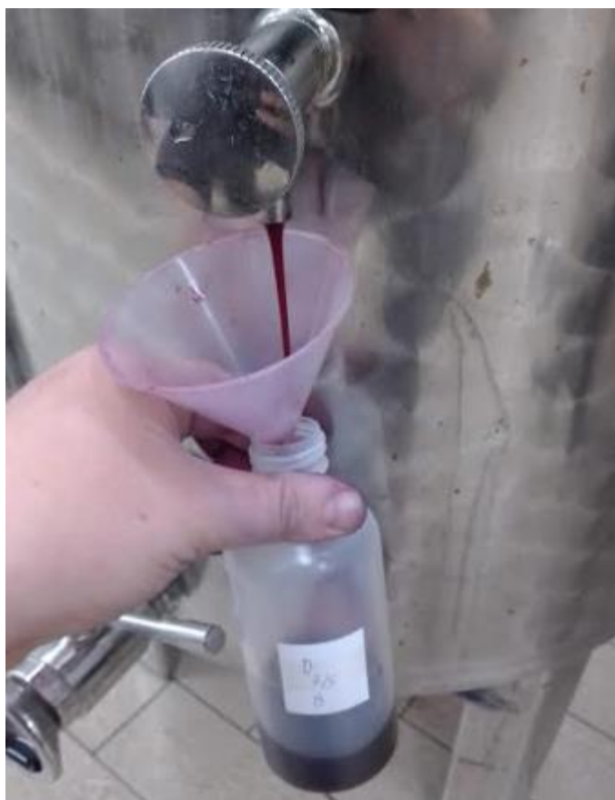
Slika 2. Način uzimanja uzoraka mošta
