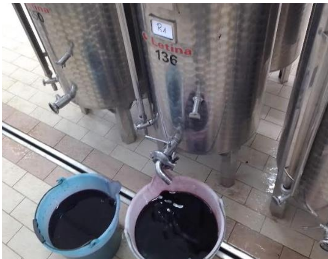
Slika 5. Odvajanje volumena mošta (20 L) tijekom remontaže
