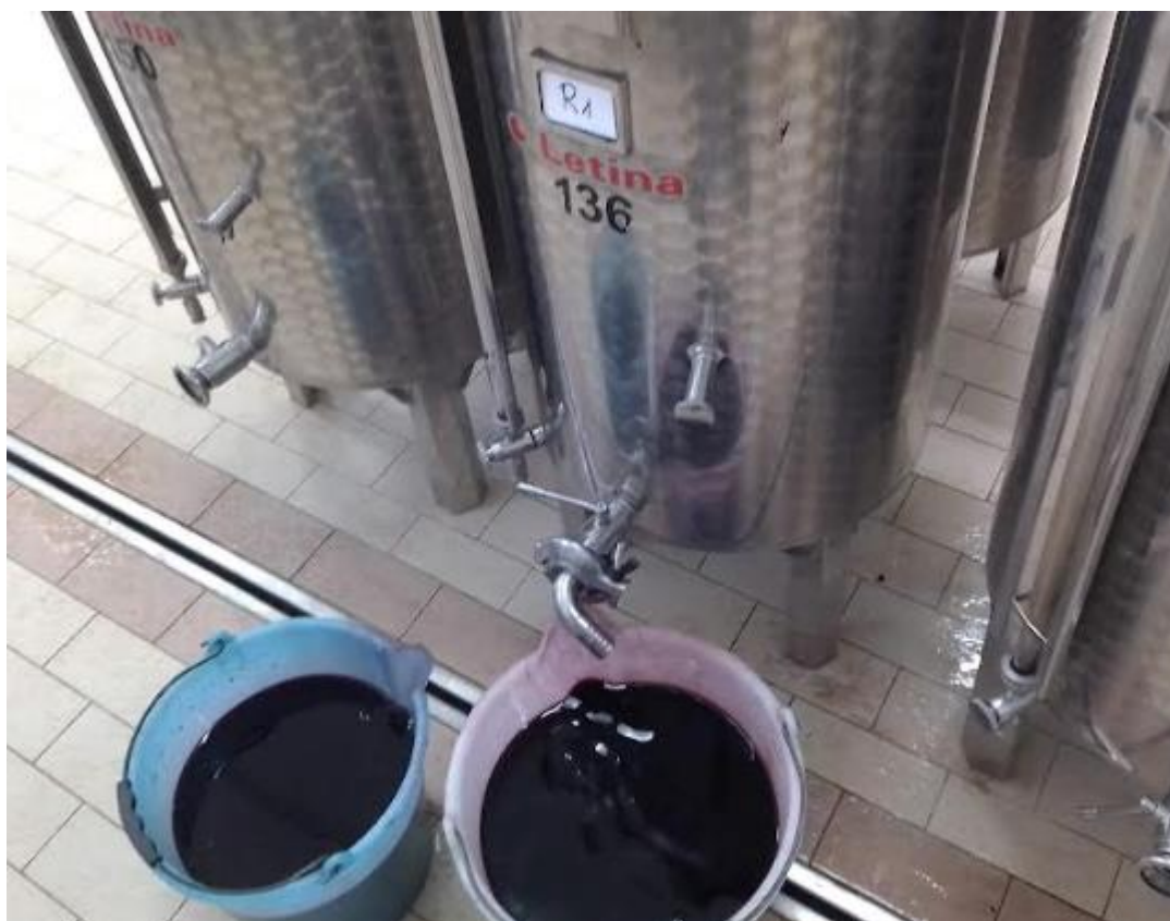
Slika 5. Odvajanje volumena mošta (20 L) tijekom remontaže
